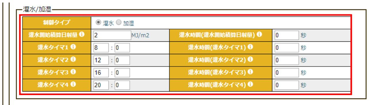
図 30 : 環境制御設定(詳細)画面 日射比例灌水設定部分
