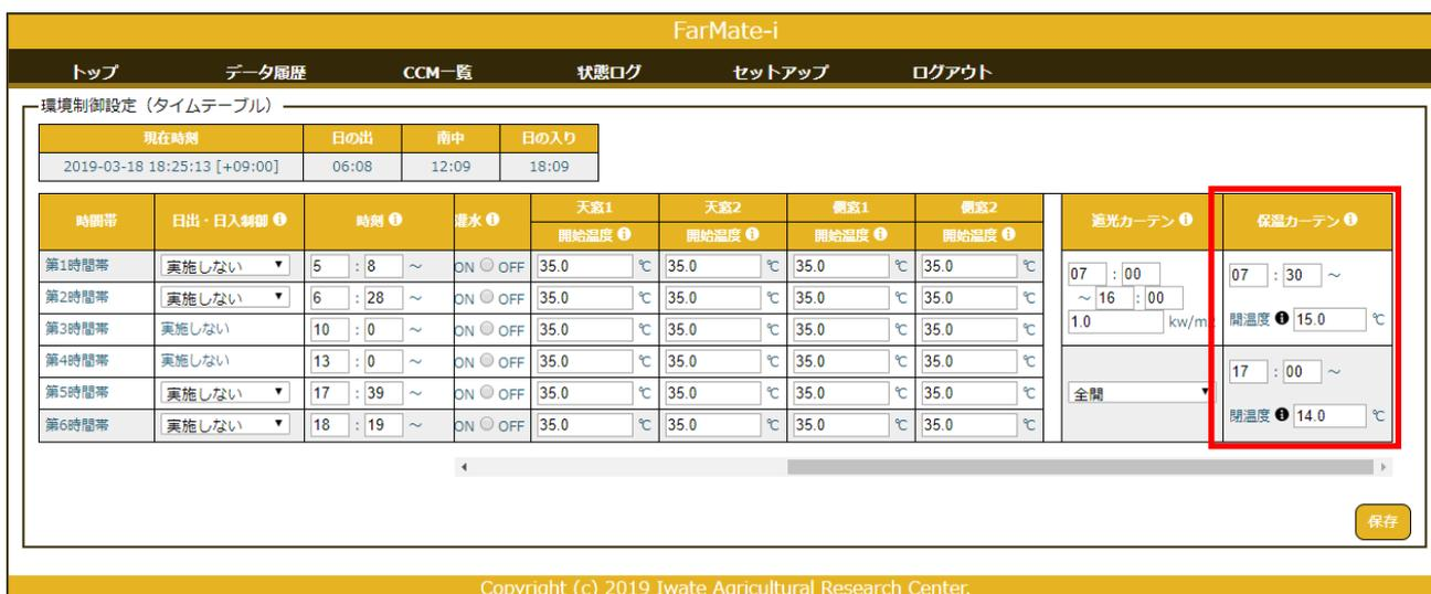
図 42 : 環境制御設定(タイムテーブル)画面 保温カーテン設定部分
