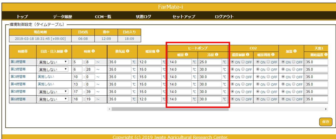
図 19 : 環境制御設定(タイムテーブル)画面 ヒートポンプ設定部分
