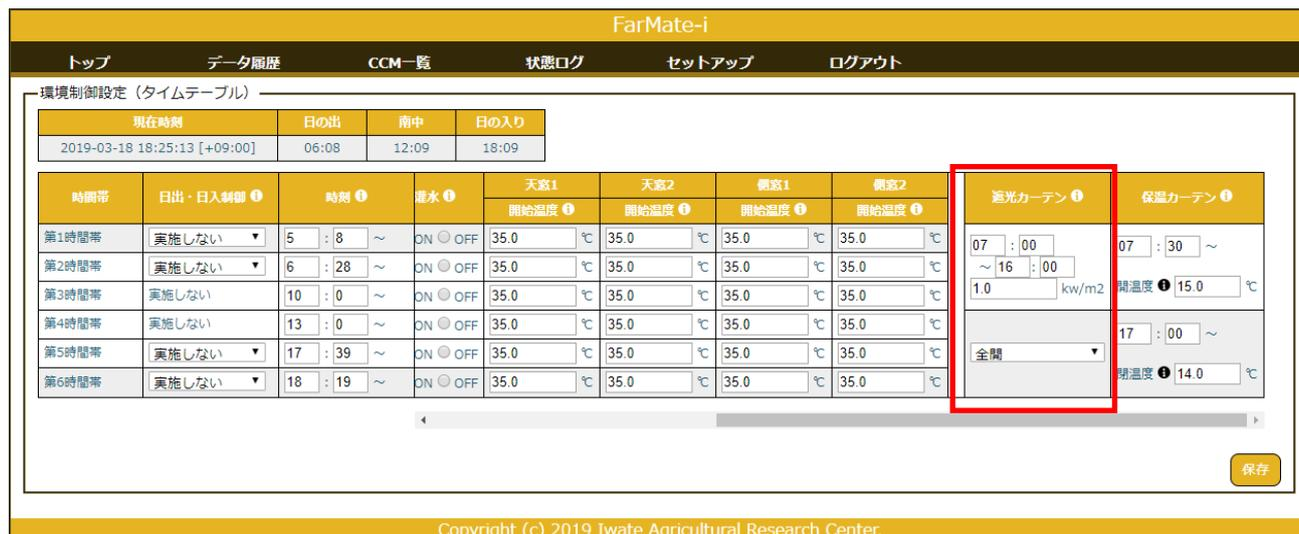
図 39 : 環境制御設定(タイムテーブル)画面 遮光カーテン設定部分
