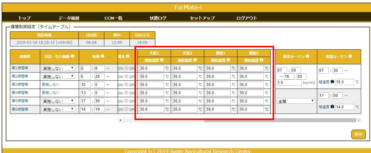
図 36 : 環境制御設定(タイムテーブル)画面 天窓、側窓設定部分
