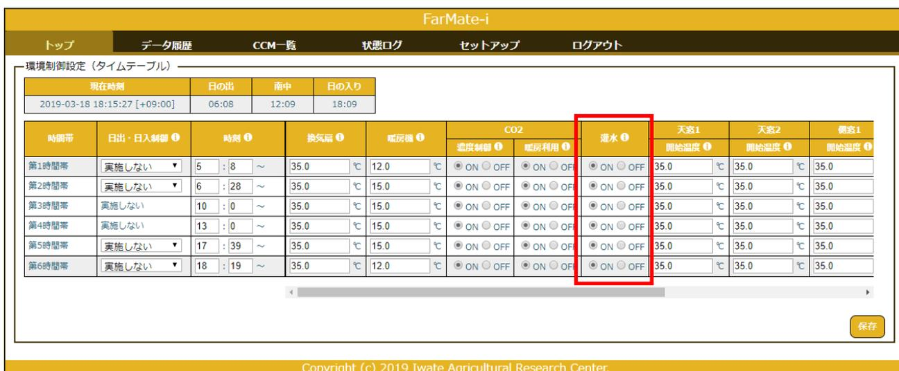
図 29 : 環境制御設定(タイムテーブル)画面 日射比例灌水設定部分
